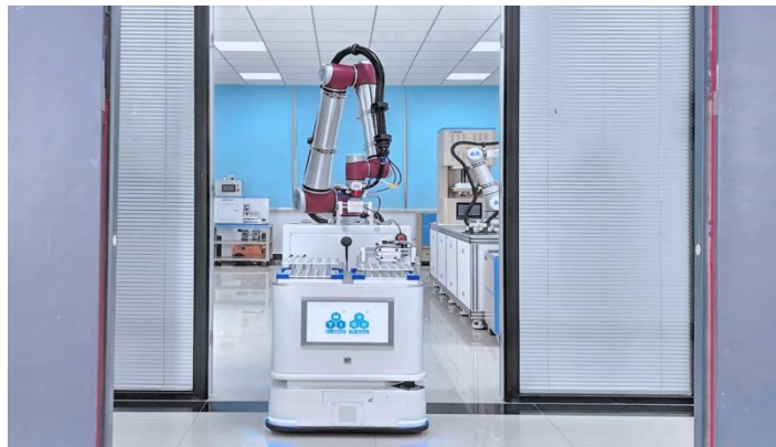
(3) AGV 参与的多房间的自动化操作 (多个全自动平台使用 AGV 设备进行串联)
